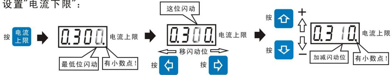
注：1、“电流下限≤实测电流≤电流上限”合格，超出这范围报警。双电压型：电流下限在高压才作用。2、如果使用时电流并没有超出电流上限，但报警，请检查电流下限的设置值!!!
